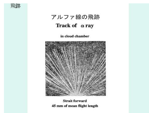
図4 霧箱で観測した \alpha 線の飛跡。平均長さが45 mm（シュポルスキー，原子物理学）
